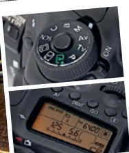
Ovan: De många alternativen på tillgångsfrågan inkluderar åtkomst till Bulb-exponering. Övrig: Den upplysta LCD-skärmen gör direkt åtkomst till AF-mätning, ISO och bländring.
